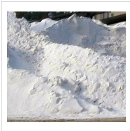
Eines der Rohstoffe zur Glasgewinnung, Quarzsand  $\text{SiO}_2$
