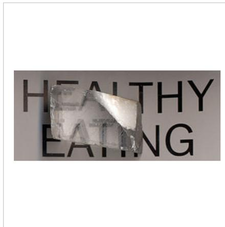
Das Mineral Calcit ist zwar transparent, aber durch eine doppelte Brechung an den Grenzflächen erscheint das Bild dahinter doppelt.
